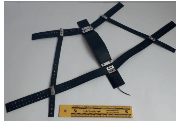
Figura 3. Arnés para oso hormiguero gigante elaborado por Telenax y Pochitroniks. Se observa la banda central con el anclaje de las bandas frontales, caudales y ventrales.
