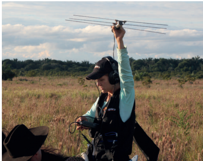
Figura 1. Uso de antena tipo Yagi para la detección de hormigueros gigantes marcados con collares VHF en Pore, Casanare.
